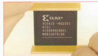
Step 4 – Align BGA with EZReball™ preform
